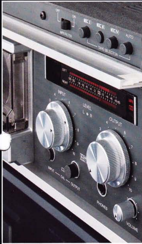
Konzentrierte Audio-Bedienungselemente: Band-sortenwahl nach IEC, Regler und Tasten für Ein- und Ausgangspegel sowie Kopfhörerpegel.
