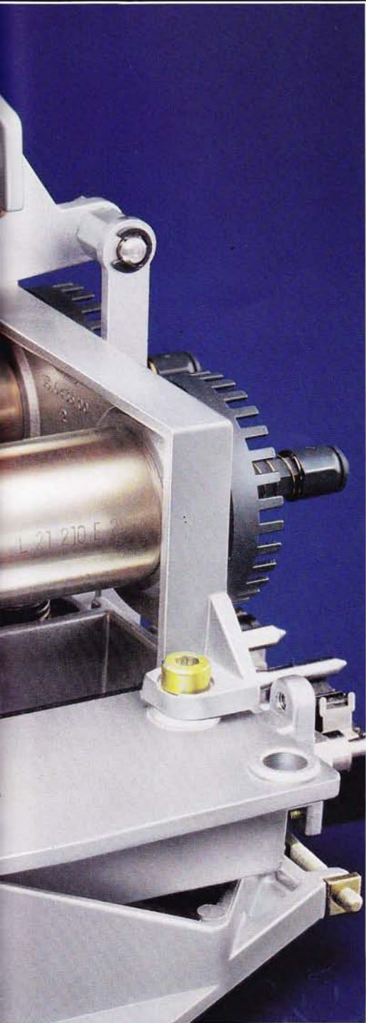
Optimales Zusammenwirken von Präzisionsmechanik und Mikrocomputerelektronik. Die aufgeschnittene Abdeckplatte gibt die Sicht frei auf den optoelektronischen Tachosensor des linken Wickelmotors.
