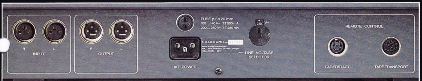
Symmetrische Ein- und Ausgänge über professionelle Steckanschlüsse und Mehrpolanschlüsse für Laufwerkfernbedienung und Faderstart, serienmässig.
